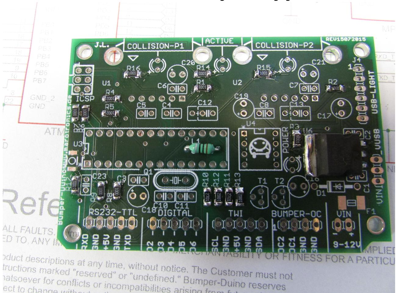
Schaltplan aufmerksamen studiert hat, dem ist sicher nicht entgangen, dass L1 und diverse Kondensatoren als Filter für die Spannungsversorgung unseres OP-AMP und der Drucksensoren dienen. Gleichzeitig wird auch der AVCC des Mega328 versorgt, wodurch sich kleine Spannungsschwankungen während der Messungen nicht so stark auswirken können.
